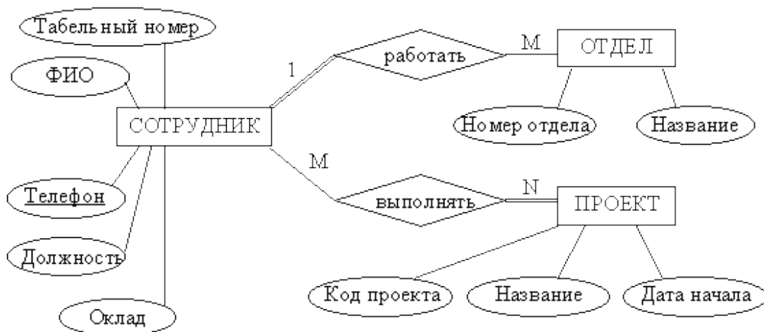
Рис.2. Пример ER–диаграммы с однозначными и многозначными атрибутами
